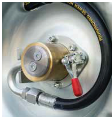
Mechanická voľnobežka RioFree na cievke hadice na navíjanie bez odporu
